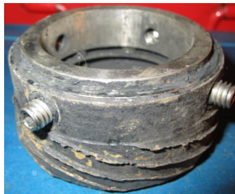
شکل ۹: پمپ رینگ برنزی خورده شده پس از یک ماه
