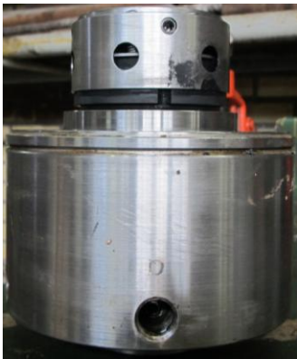
شکل ۷: نمای نشت‌بند مکانیکی
