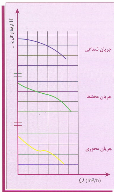
شکل ۲-۱ مقایسه منحنی مشخصه H-Q پمپ‌های جریان شعاعی، مختلط و محوری
