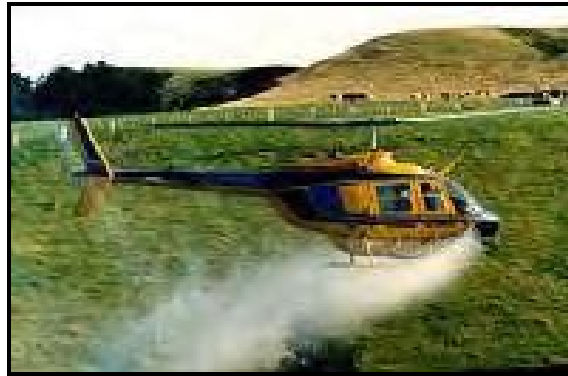
شکل ۲-۸- سیستم‌های اسپری ثابت برای هلی‌کوپترها (REMPEC, 2011)
