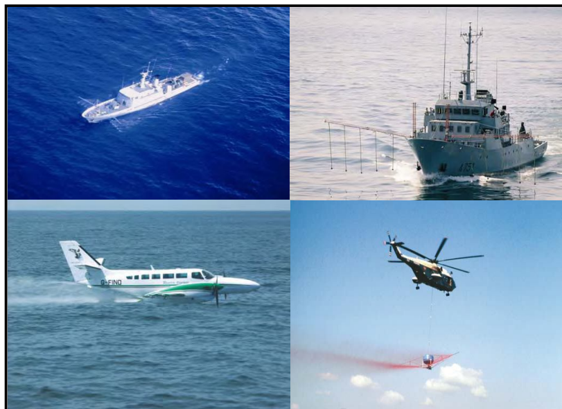
شکل ۱-۲- حالت‌های مختلف اسپری دیسپرسنت در شناورها، هواپیماها و بالگردها (REMPEC, 2011)
