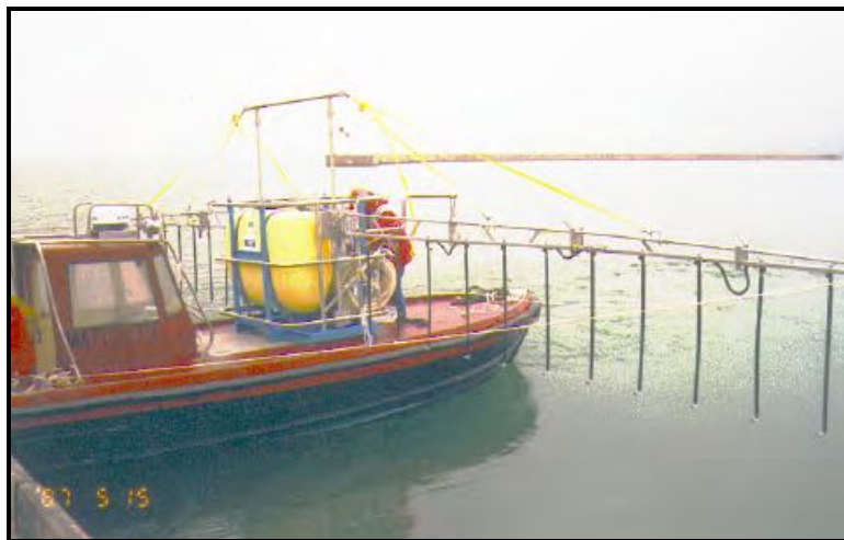
شکل ۲-۳- سیستم اسپری دیسپرسنت معمولی در قایق‌ها (REMPEC, 2011)
