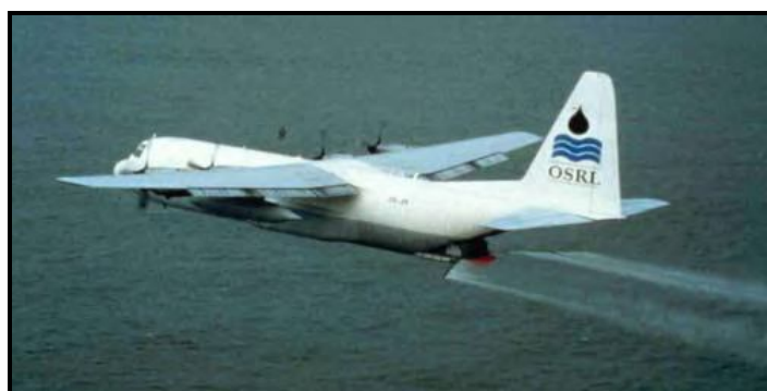
شکل ۲-۷- سیستم‌های پاششی هوابرد (با ۲۰ تن ظرفیت) (REMPEC, 2011)
