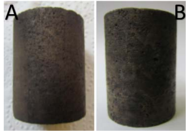
شکل (۵): شماتیک مغزه مورد آزمایش (A) قبل از پیر شدگی (B) بعد از پیرشدگی
