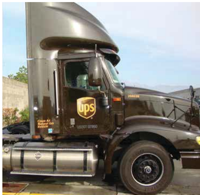
شکل ۴: یک نمونه خودروی سنگین LNG سوز، وارد شدن این خودروها و همچنین ساخت موتور هواپیما و موتورهای بسیار بزرگ کشتی با سوخت LNG نوید بخش گسترش بیش از پیش استفاده از این حامل انرژی به جای سوخت‌های مایع و حتی CNG می‌باشد.
