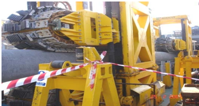
شکل ۷: خط لوله در گیر بین Tensioner_بارج PLB132
