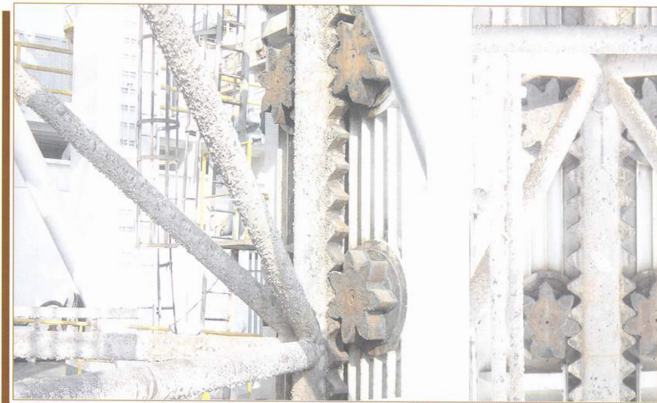
شکل (۲-۱۲) - سیستم Jacking از نوع Rack & Pinion
