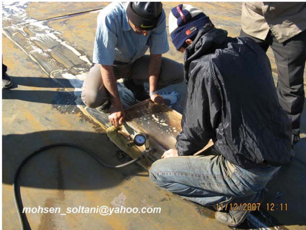
شکل ۱۱- عملیات تست و کیوم ورقهای کف مخزن
