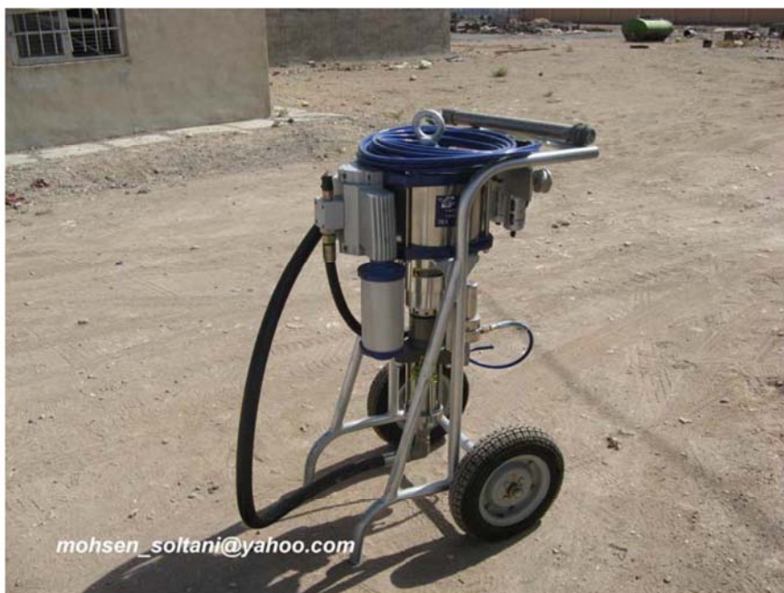
شکل ۵۵- دستگاه ایرلس جهت انجام عملیات رنگ آمیزی
