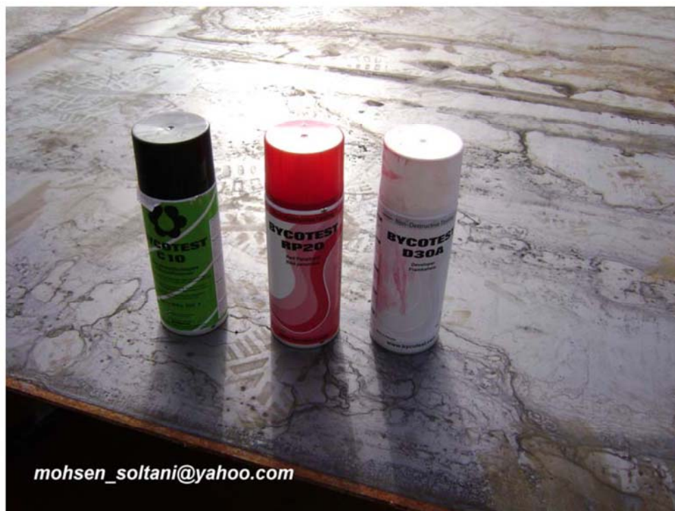
شکل ۲۶_ مواد مورد استفاده در تست PT
