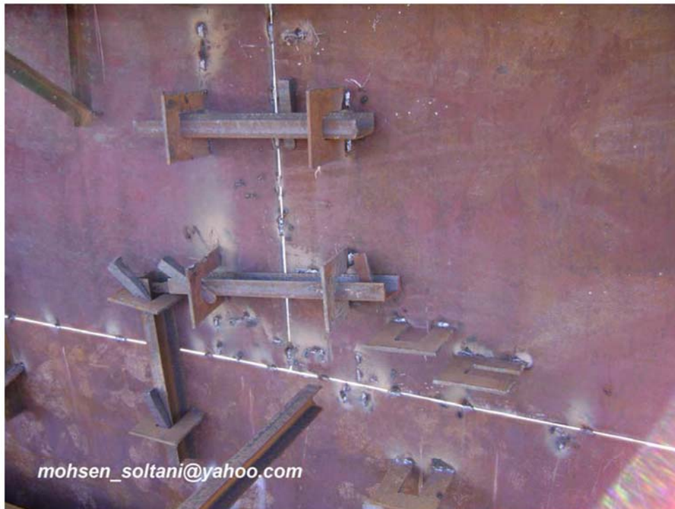
شکل ۱۸_ رعایت فاصله بین ورقها (Gap)
