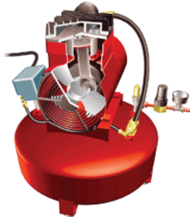
شکل 1-16- کمپرسور پیستونی با پنکه جهت خنک کردن هوا
