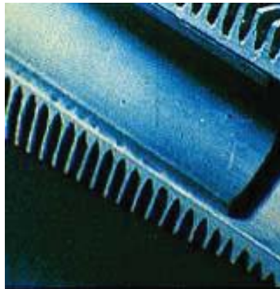
شکل 15-5- یک نمونه از پره‌های Extruded که روی لوله‌ای ایجاد شده‌اند
