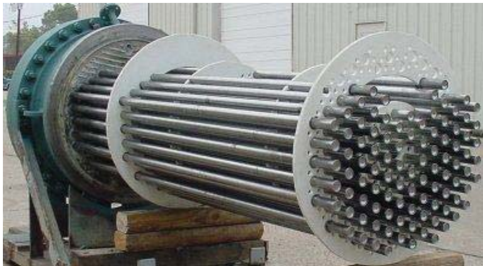
شکل 3-18 - آرایش مثلثی لوله ها، صفحه تیوب و بافل ها در یک مبدل پوسته و لوله
