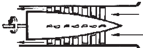
شکل 16-4- شبیه سازی ساده ای از نحوه حرکت سیال در کمپرسور جریان محوری
