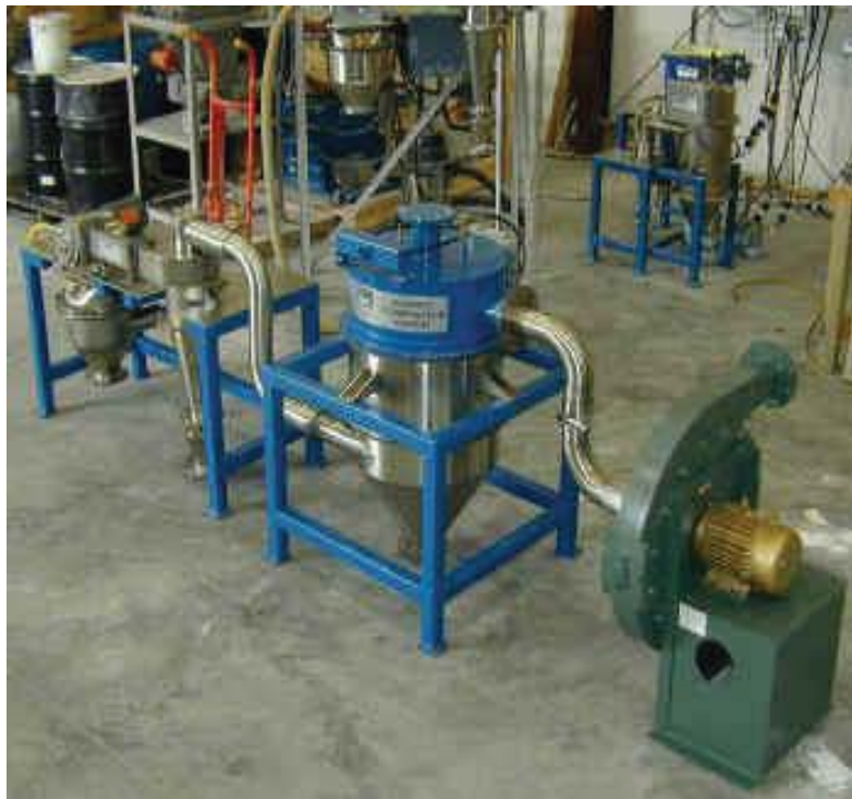
شکل 14-5- در این شکل، دمنده بعد از سیکلون قرار گرفته است
