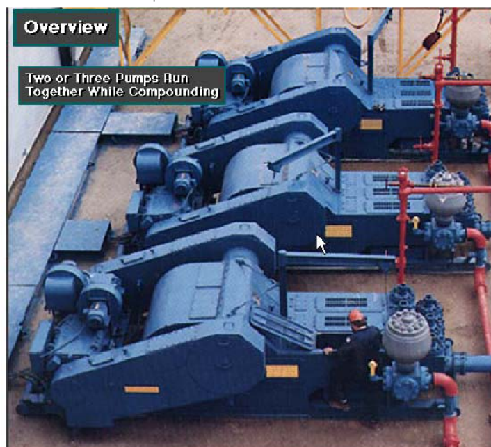
دستگاه حفاری یا از پمپ دو گانه استفاده می‌کند
