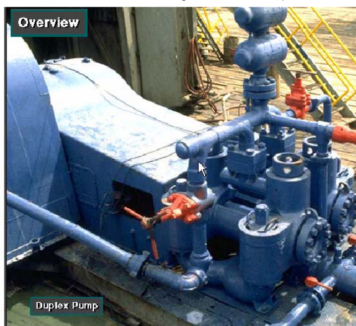
دستگاه حفاری یا از پمپ دو گانه استفاده می‌کند
