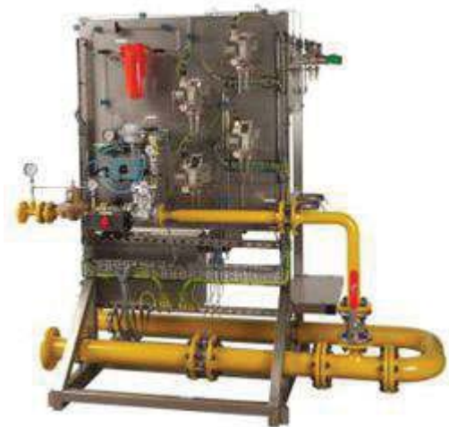
شکل ۳. پکیج نمونه بردار و آنالایزر سنجش پارامترهای کیفی مایعات
