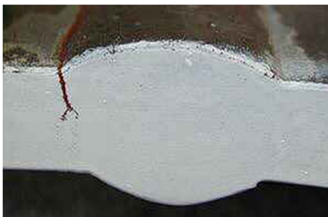
عیب ترک جوش (یکی از انواع آن)
