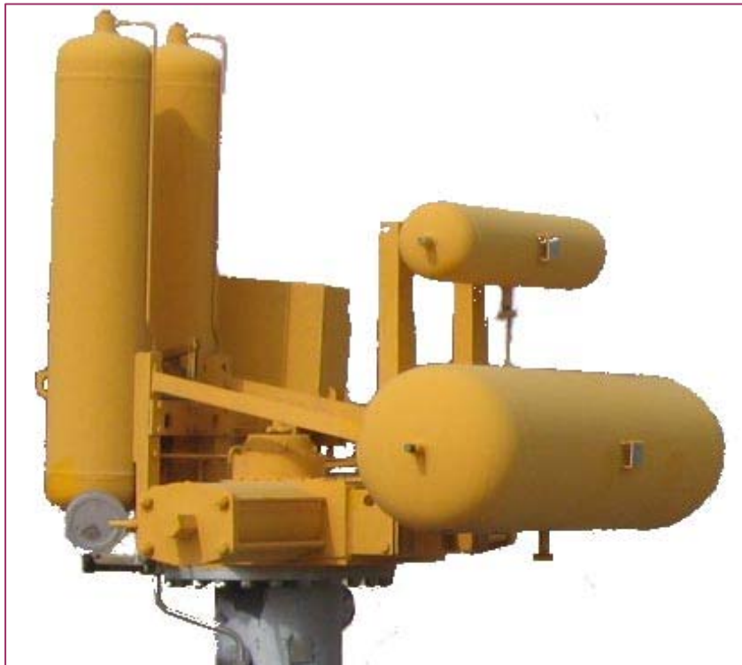
شکل ۱۳-۴ - عملگر ۴ سیلندر (بالا) و تک سیلندر (پایین) لدین ایتالیا
