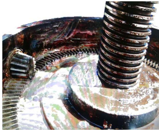
شکل ۱۴-۳ - یک عملگر هیدرو استاتیکی با اربیت موتورهای افقی، بالا - تصویر واقعی چرخنده‌ها، پایین
