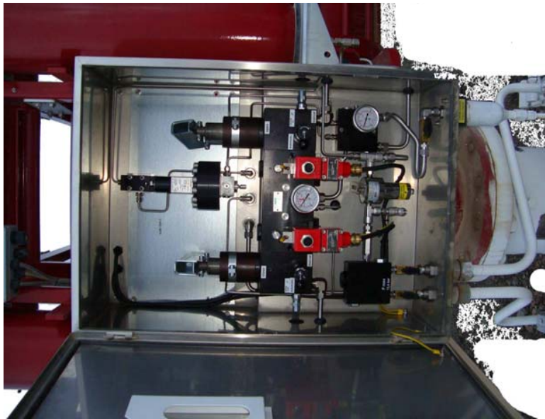
شکل ۲۱-۴ - شکل عمل کننده روتورک
