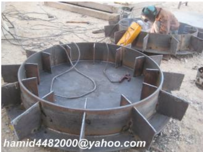
شکل 41 - ساخت Central Compression Ring
