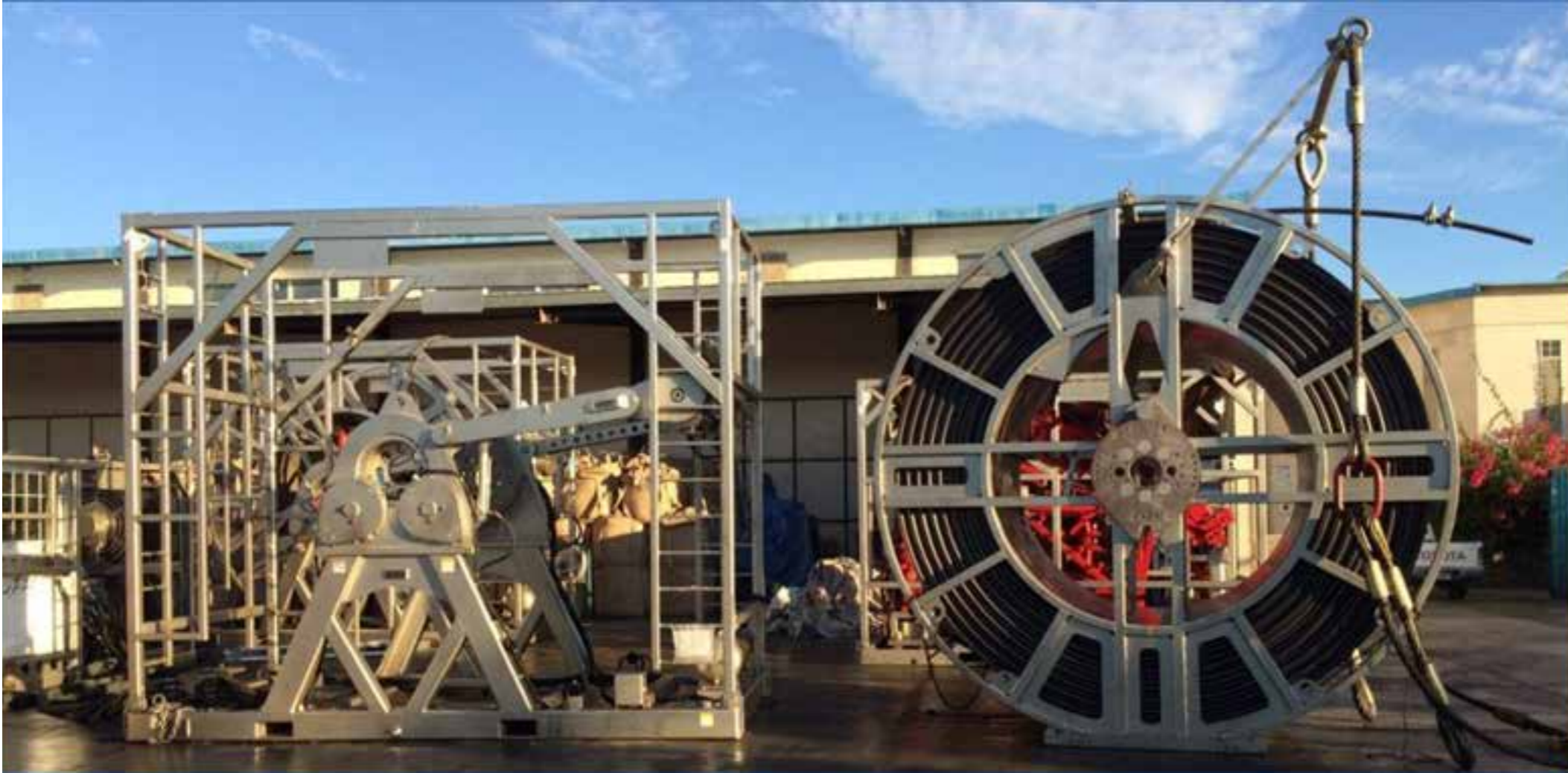
شکل ۳- جداسازی لوله از چارچوب قرقره برای جابجایی درایی
