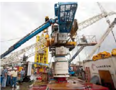
شکل ۹ | تخلیه Three Rams Capping Stack
