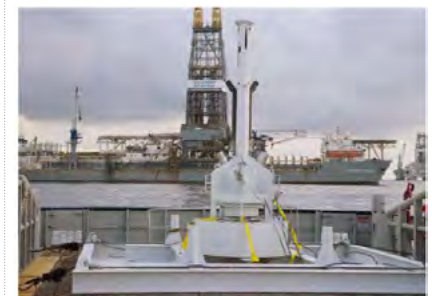
شکل ۶ | Top Hat استفاده شده در مهار چاه Macondo
