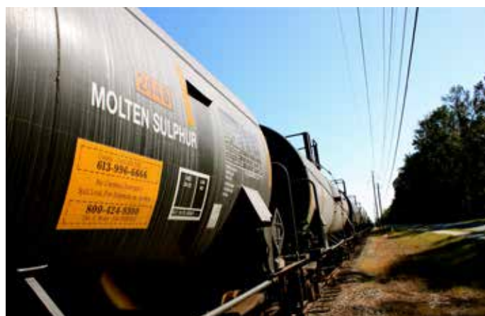
شکل ۹: حمل گوگرد مایع [مذاب] به وسیله تانکر ریلی
