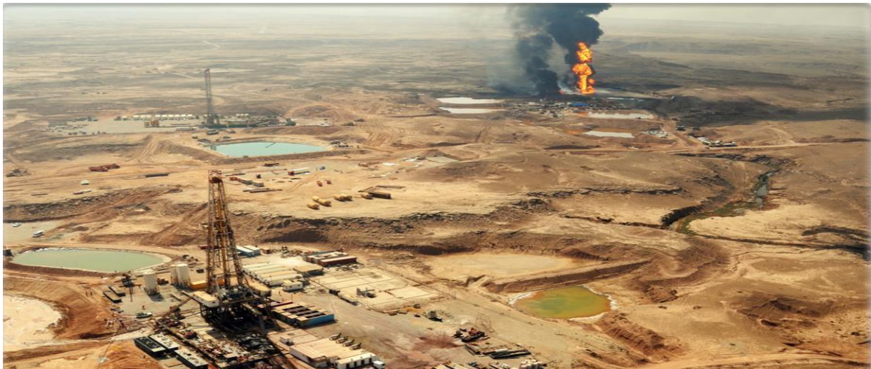
شکل ۳: نمایی از دو دکل در حال حفر چاه امدادی
