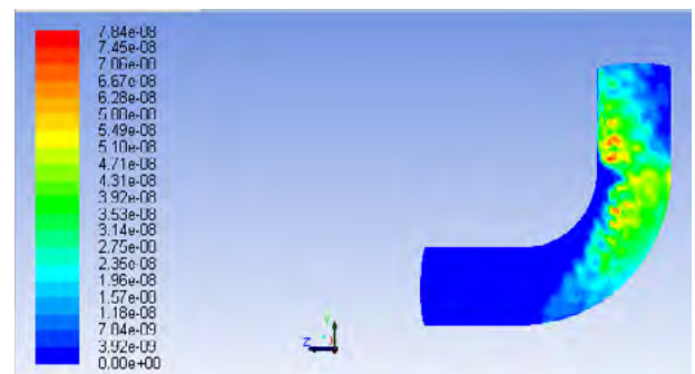
شکل ۱۳ | نمای جانبی از کانتور سایش در فشار ۱۰۰ psi (برای جریان دارای ذرات ۵ میکرون)
