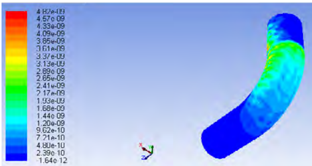
شکل ۲۵ | کانتور سایش در فشار طراحی ۲۵۰ psi (برای جریان دارای ذرات ۱۰ میکرون)
