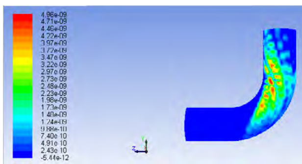
شکل ۷ | نمای جانبی از کانتور سایش در فشار طراحی ۲۵۰ psi (برای جریان دارای ذرات ۵ میکرون)
