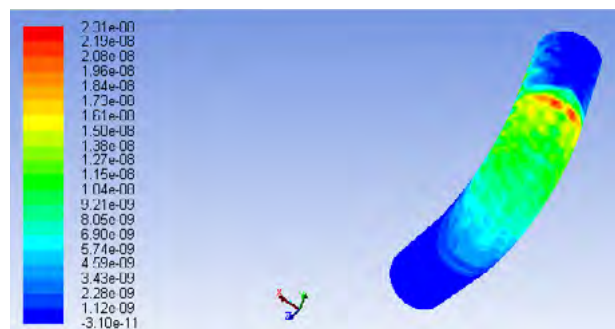
شکل ۲۸ | کانتور سایش در فشار ۱۵۰ psi (برای جریان دارای ذرات ۱۰ میکرون)
