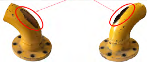
نمونه واقعه‌ای از ساییش در زانو یکی از ایستگاه‌های تقلیل فشار در صنعت گاز | شکل ۲۳
