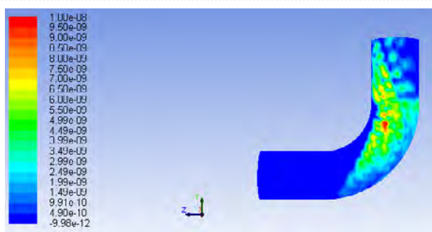
شکل ۹ | نمای جانبی از کانتور سایش در فشار ۲۰۰۰ psi (برای جریان دارای ذرات ۵ میکرون)
