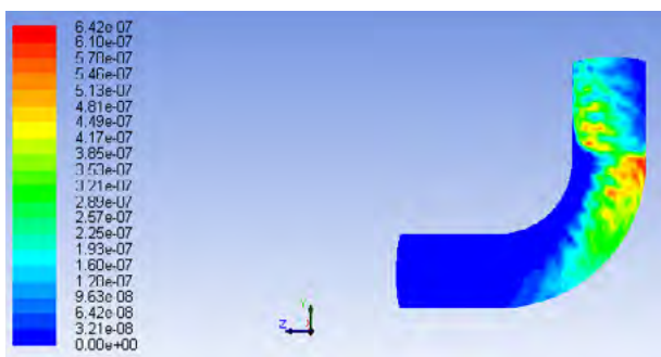
شکل ۱۵ | نمای جانبی از کانتور سایش در فشار ۵۰ psi (برای جریان دارای ذرات ۵ میکرون)
