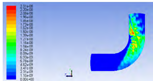
شکل ۱۱ | نمای جانبی از کانتور سایش در فشار ۱۵۰ psi (برای جریان دارای ذرات ۵ میکرون)
