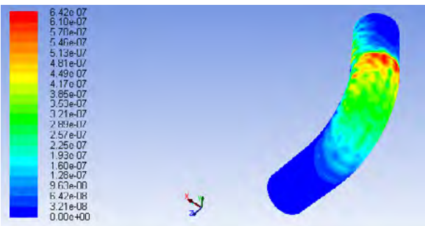
شکل ۱۶ | کانتور سایش در فشار ۵۰ psi (برای جریان دارای ذرات ۵ میکرون)
