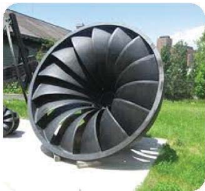
نمونه ای از پره مورد استفاده در توربین های آبی
