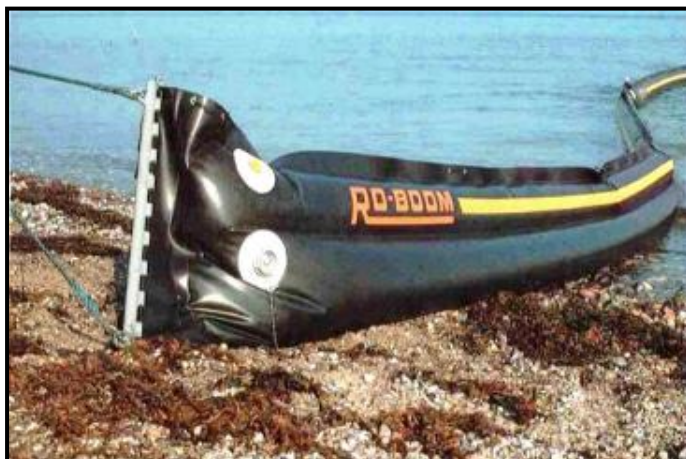
شکل پ.۴-۲۳- نمونه‌ای از بوم‌های مخصوص ساحل
