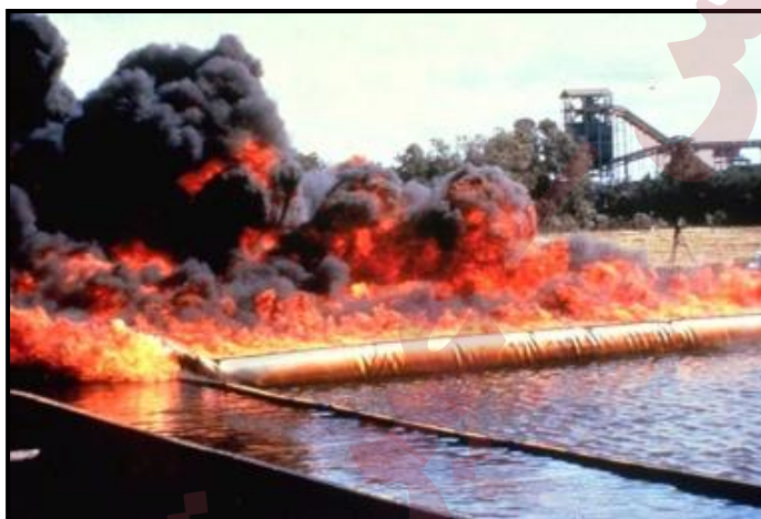
شکل پ.۴-۲۴- نمونه‌ای از بوم‌های ضد حریق
