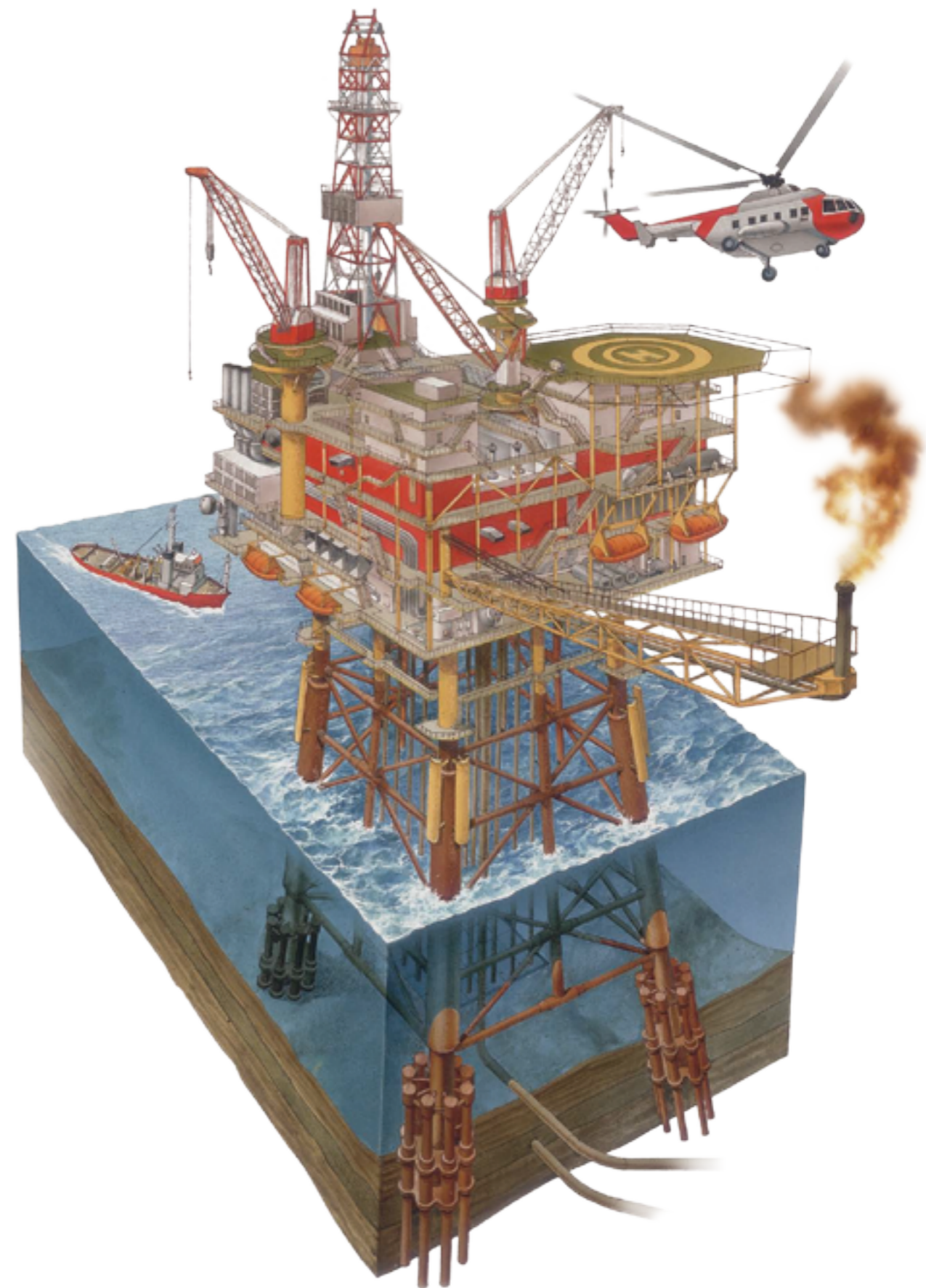
شکل ۳: یک سکوی نمونه از نوع شابلونی
