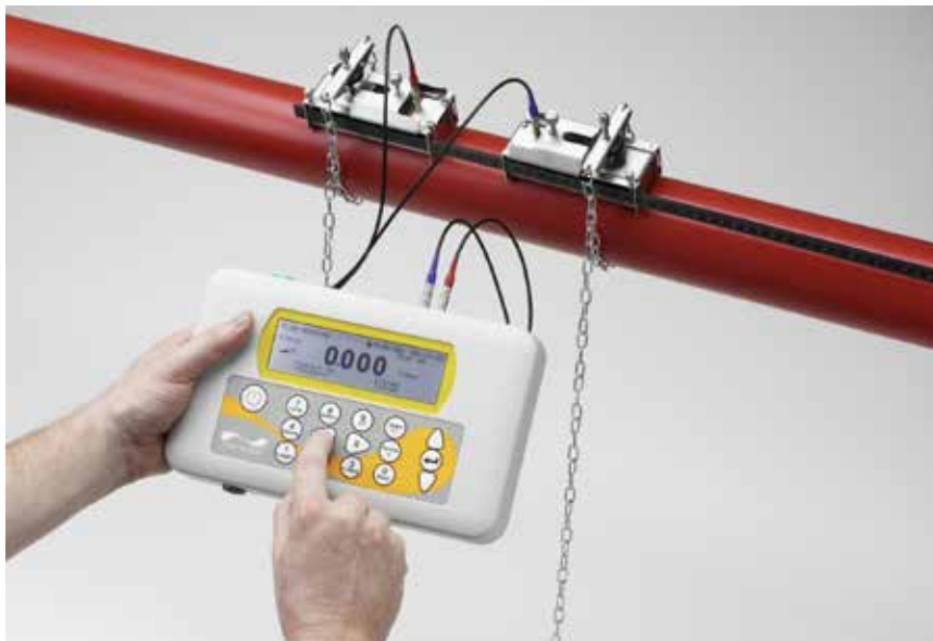
شکل ۸: فلومتر اولتراسونیک از نوع Clamp-On
