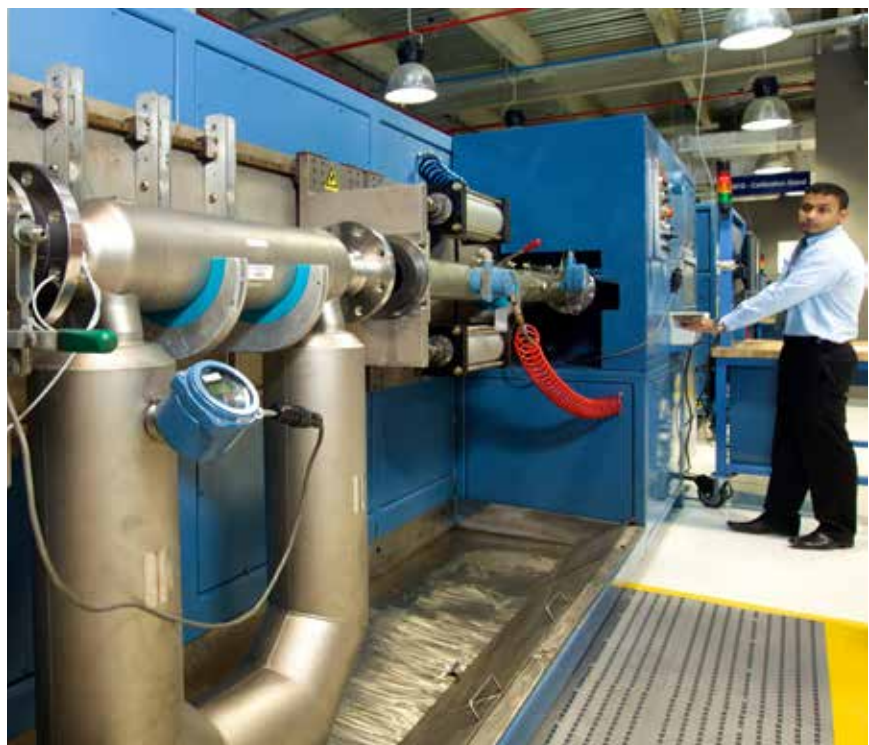
شکل ۱۴: کالیبره کردن جریان سنج کوریولیس
