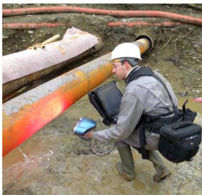
شکل ۲: کاربرد عملی وسیله اسکنر سه بعدی
