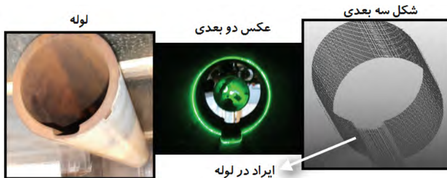
شکل ۱۰: نمایشی از تشخیص ایراد در لوله
