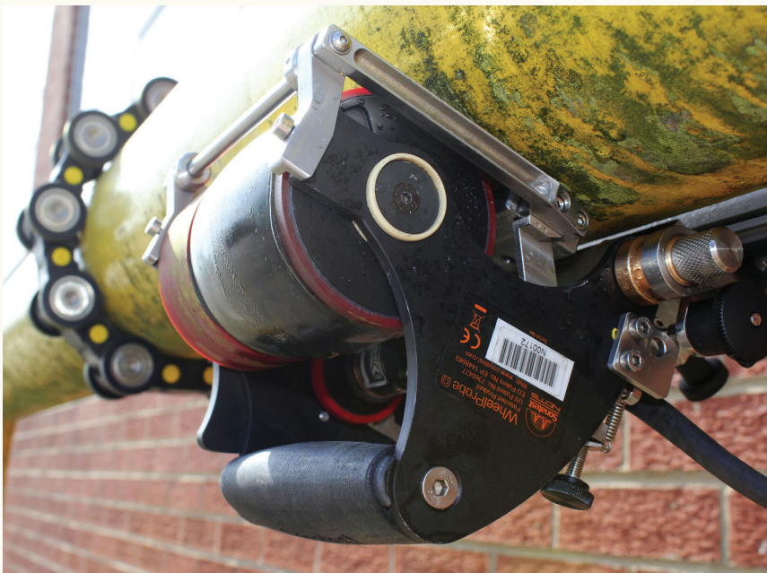
شکل ۲: یک نمونه دستگاه تست اولتراسونیک
