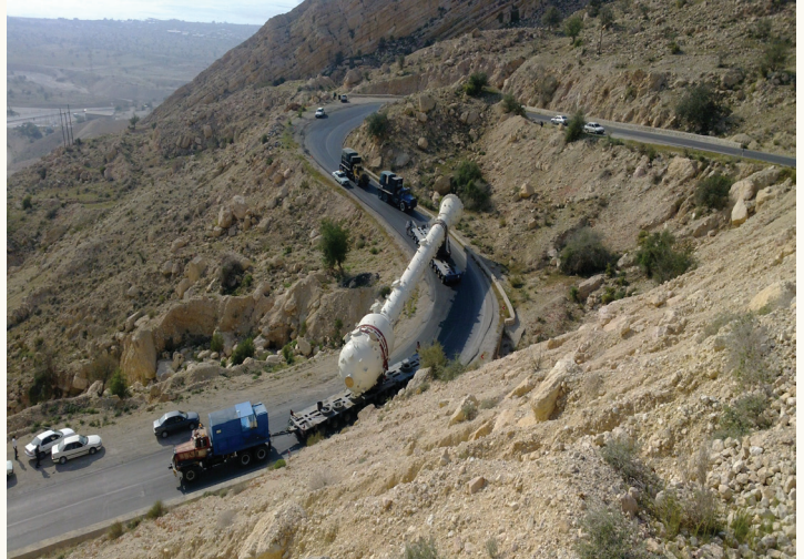
شکل ۱۵: حمل یکی از بزرگترین و سنگین ترین تجهیزات پالایشگاه فازهای ۱۵ و ۱۶
