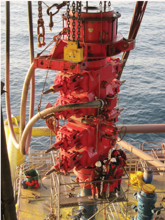
شکل ۱۶: یک دستگاه [Blow Out Preventer] BOP
