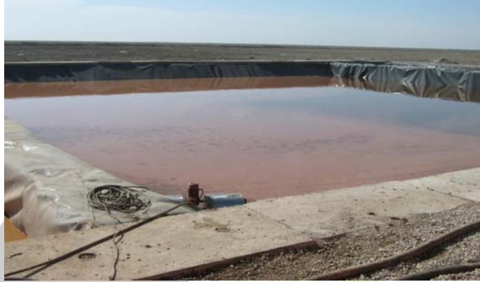
(شکل شماره ۶) : تصویری از گودالی بزرگ جهت ذخیره پسماند در اطراف یکی از دکلهای شرکت ملی حفاری ایران
