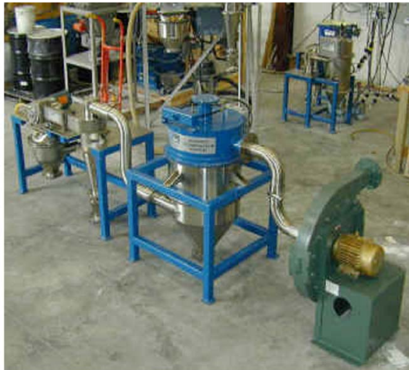
شکل 14-5- در این شکل، دمنده بعد از سیکلون قرار گرفته است
