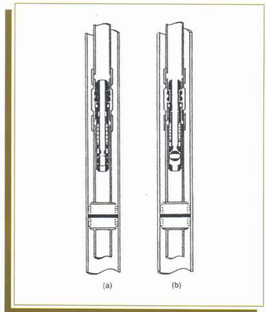
شکل ۵۲- شیرهای اطمینان اختلاف فشاری
