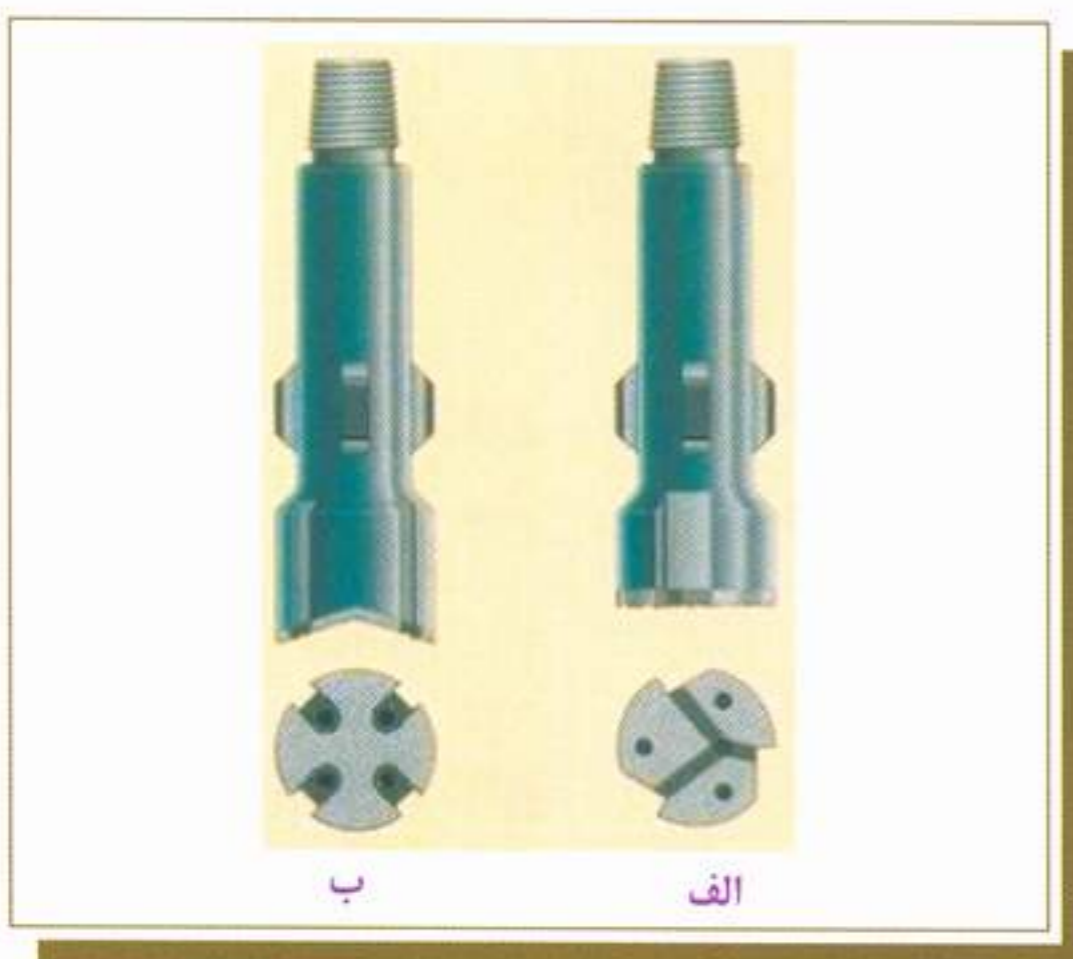
شکل ۲۰- الف) مته مانده آسیاب کن افست ب) مته مانده آسیاب کن محدب
