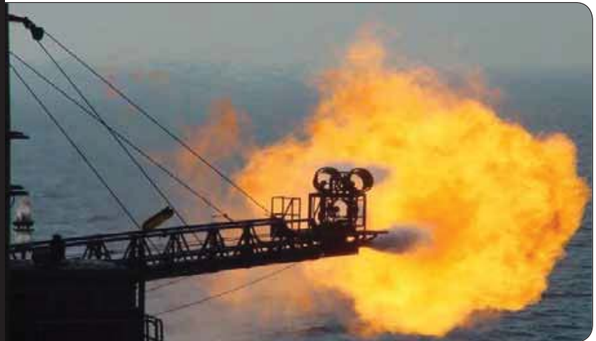
شکل ۲: یک نمونه از فلر نصب شده بر روی سکوی دریائی
