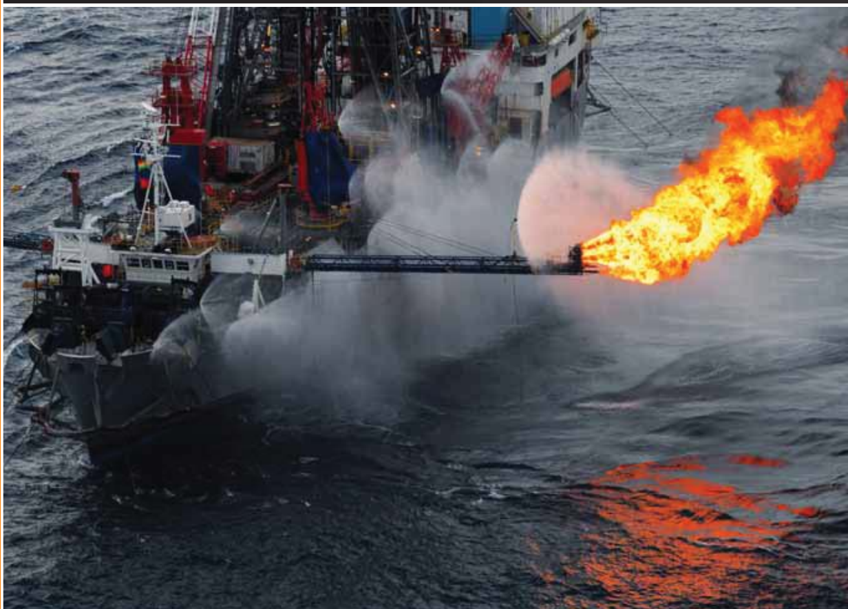
شکل ۵: یک نمونه از فلر نصب شده بر روی کشتی بهره‌بردار FPSO
