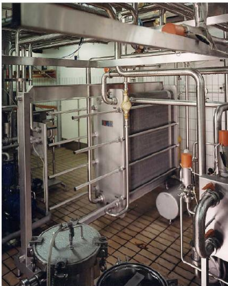
شکل (۹-۱): کاربرد فرآیندی یک مبدل حرارتی صفحه ای
