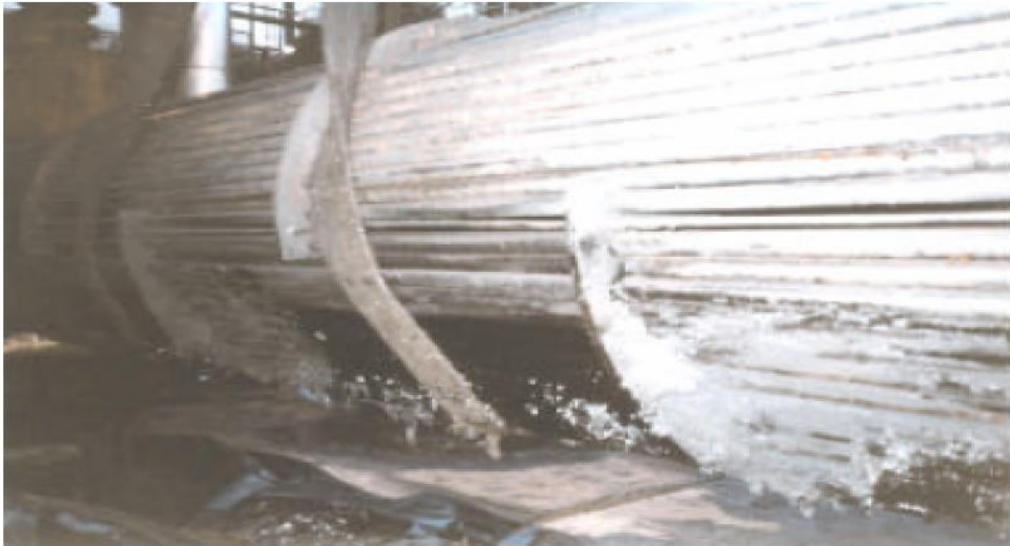
شکل (۲-۱۷): تجمع رسوب در مناطق ساکن بافل‌های قطاعی
