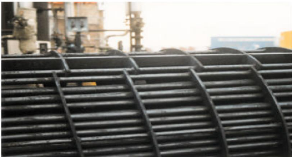
شکل (۲-۱۸): رسوب بسیار ناچیز در بافل‌های حلزونی
