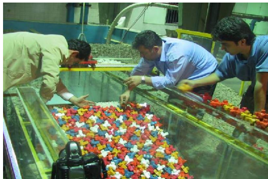
Fig. 8) Xbloc ® armor layer under Construction
